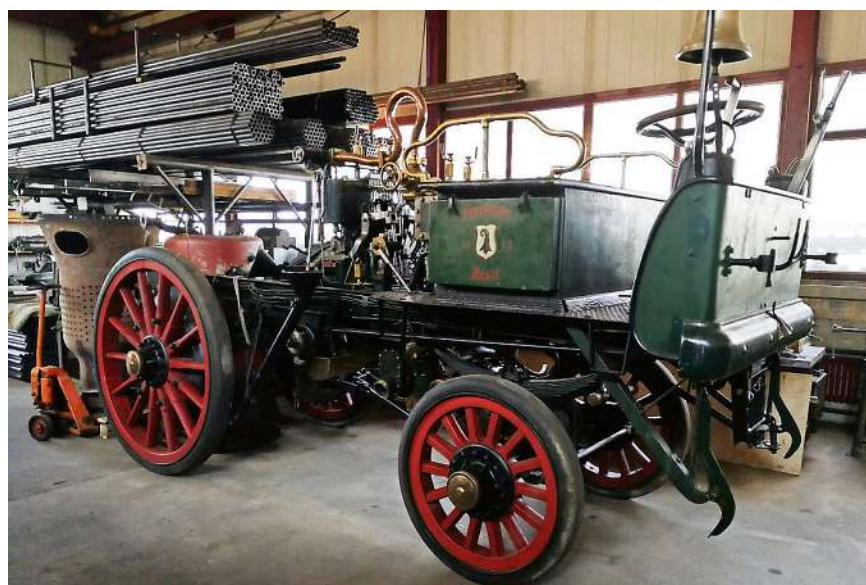
Historisches Gefährt. Die Dampfspritze gehört der Berufsfeuerwehr Basel. Ganz links neben dem Rad steht der ausgebaut Kessel. Fotos Markus Wüest
